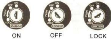
**OFF:** Gesamter Stromkreis ist unterbrochen, Motor und Lichter lassen sich nicht einschalten. Der Zündschlüssel kann entfernt werden.
