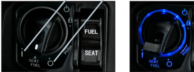
**Keyless Fernbedienung:** Die Fernbedienung muss in der Nähe des Fahrzeugs sein. Drücken Sie das Schloss, es leuchtet blau auf.
