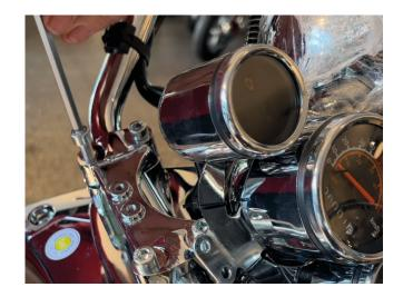
Setzen Sie die Haltestange auf und befestigen Sie diese anschließend wieder mit den Sechskantschrauben. Das Ganze wiederholen Sie auf der rechten Seite.
