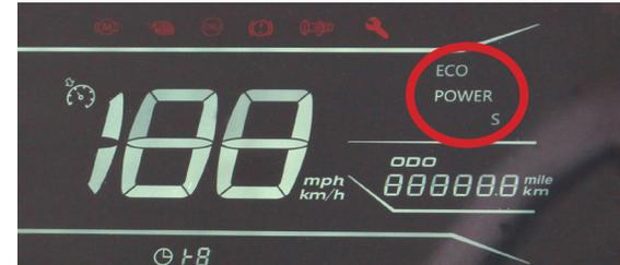
Für kurze und langsame Strecken empfiehlt sich der Modus "ECO" (max. 50 km/h). Für den alltäglichen Gebrauch empfiehlt sich der Modus "POWER" (max. 60 km/h). Wollen Sie etwas schneller an Ihr Ziel gelangen, nutzen Sie den Modus "S" für Sport (max. Geschwindigkeit).
