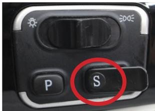
Bei dem Elektroroller HYPE 85 km/h kann man zwischen drei verschiedenen Power-Modi wechseln. Dafür betätigen Sie den Schalter "S" am rechten Griff unter dem Lichtschalter.
