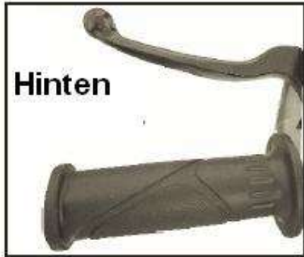
Bremshebel Hinterradbremse, gleichmäßig ziehen
